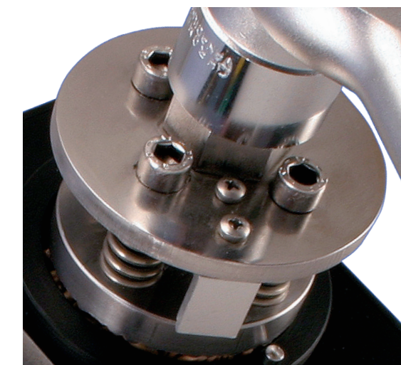
очень прочная измерительная камера с датчиком температуры и дробильными дисками из закаленной оцинкованной инструментальной стали
